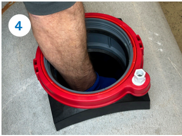
Anschluss bis zum Anschlag einschieben
